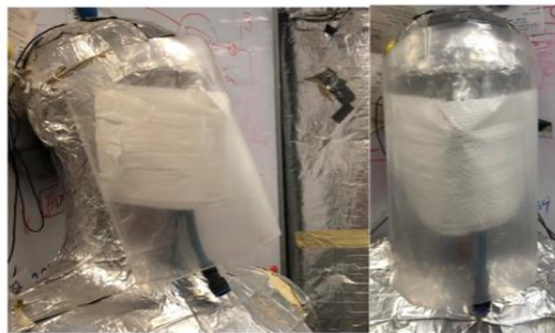
(圖7) 螢光劑測試顯示面罩有效阻擋大量飛沫
